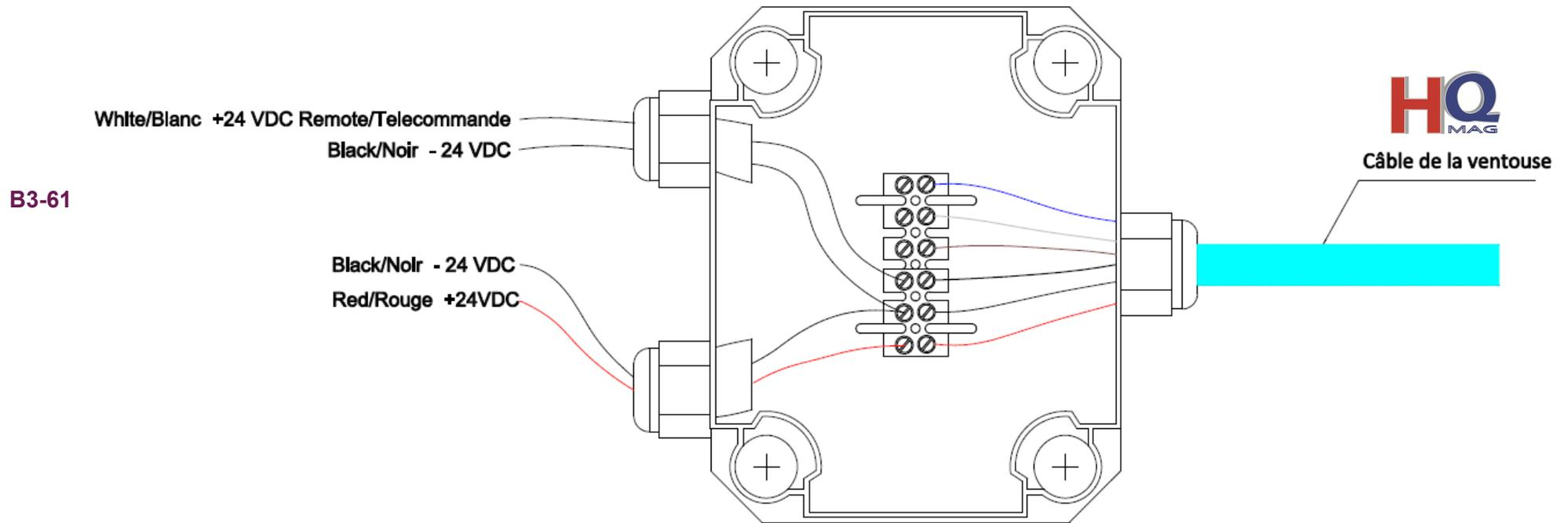
Le câblage doit être réalisé suivant la norme NFS 61932 qui précise les types de câblage à utiliser (1 mm<sup>2</sup> min. pour des câbles souples ou 1,5 mm<sup>2</sup> min. pour des câbles rigides, catégorie C2).
